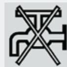
Las juntas de FKM no deben emplearse en instalaciones de gas ni en instalaciones de agua potable
