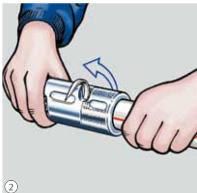
2 Desmonte el extremo de la tubería con el pelador de tuberías.
