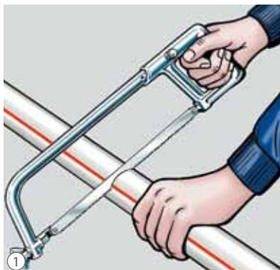
1 Tubería Prestabo desmontada corte la tubería a una longitud en un ángulo lo más recto posible con una sierra de dentado fino.
