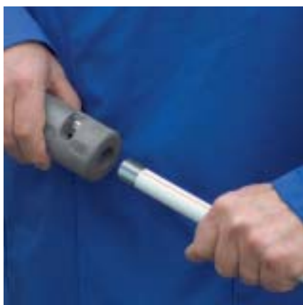
El pelador Viega para el revestimiento de PP blanco de los tubos Prestabo.
