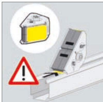
El lado corto del elemento de unión Steptec en un lado abierto del carril.
