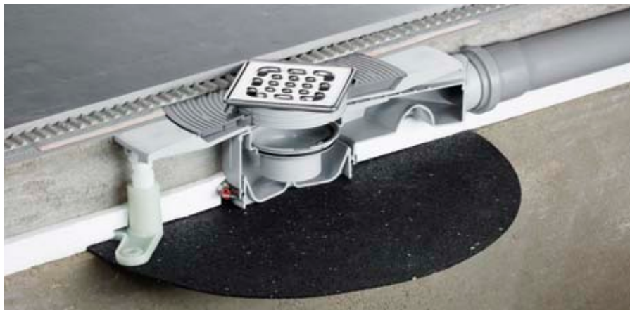
Sumidero Advantix Top con seguro contra la absorción de retorno gracias a la barrera de agua de cierre con abertura central de paso y bolsas de retención laterales.
